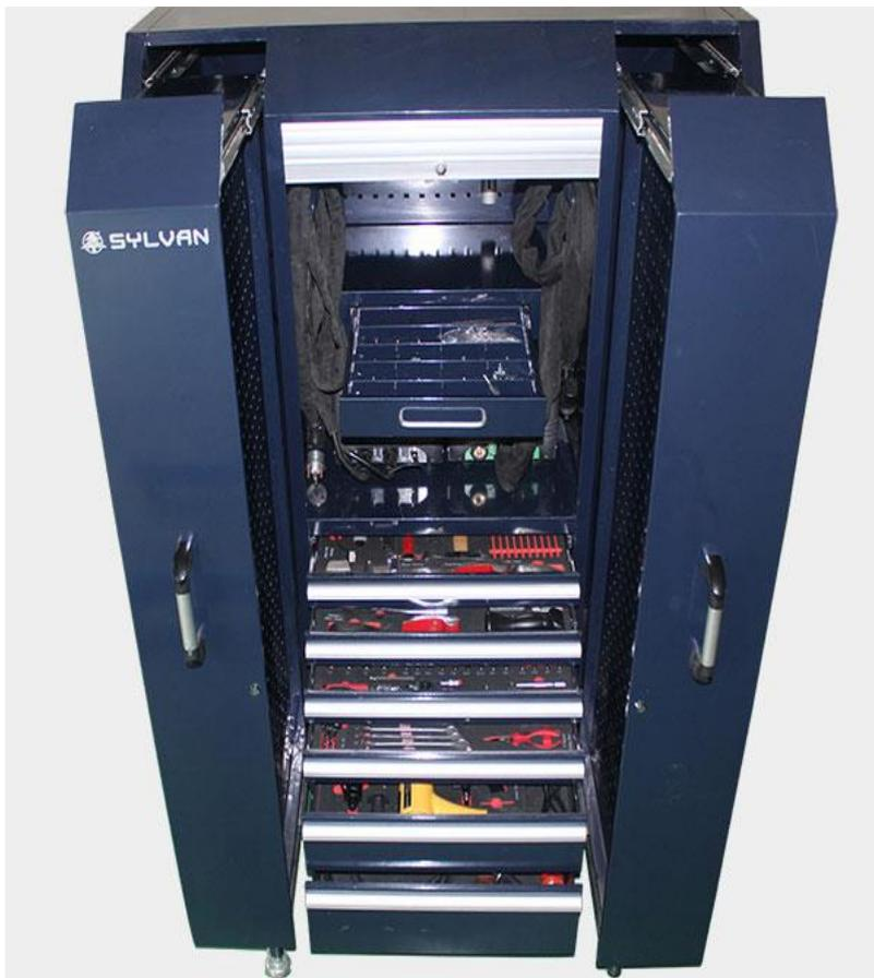
专门应对汽车小事故钣金修复的一体化工作站。常规钣金凹陷都可以使用这个工作站解决，工作站还配备了无损修复套装，对漆面无损伤的钣金凹陷，也能快速修复。
